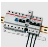
无论是 S200 还是 F200 系列，均为特殊快速卡装设计，向上轻轻扳动便可拆下，无需借助螺丝刀方便拆卸
